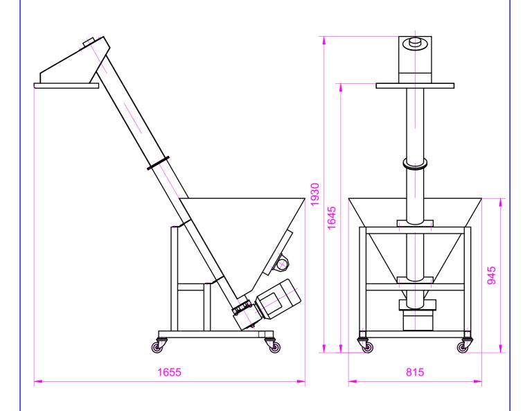
Peso del elevador vacío: 90 Kg Voltaje: 380V trifásica Potencia del elevador: 450W Características tornillo: ø90 paso 90
